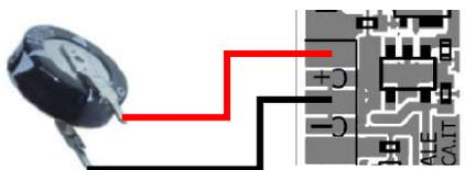
Figura 2: Collegamento condensatore
